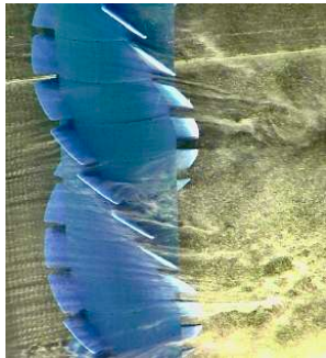
Figura 27: Visualização do escoamento ao redor de strakes não convencionais com aletas seccionadas e torcidas. Reproduzido de Assi et al. (2021).
