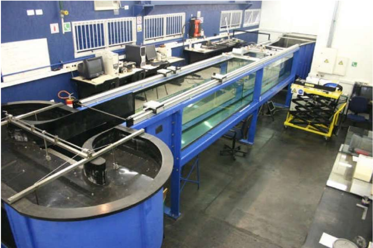
Figura 37: Canal de Água Recirculante do NDF USP. Reproduzido de Assi (2005); Assi et al. (2005).
