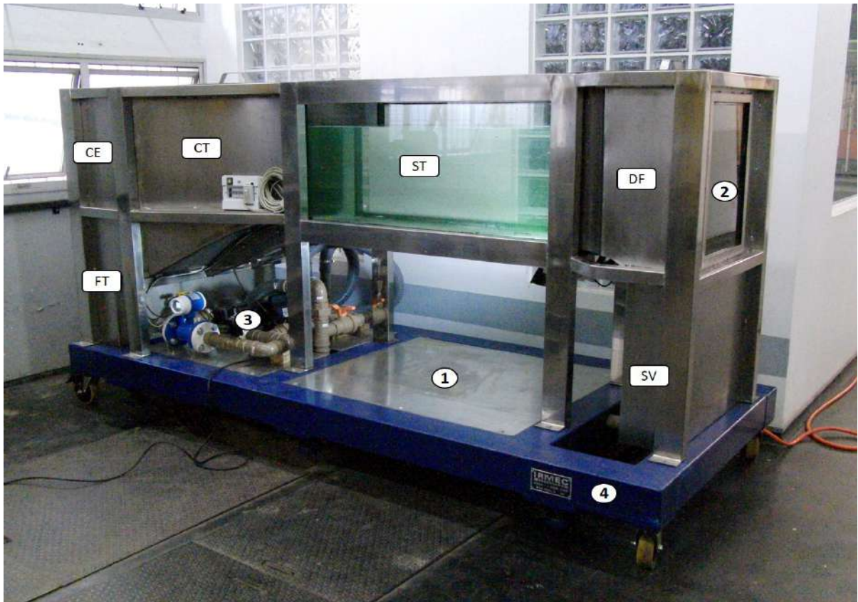
Figura 38: Canal recirculante de baixo número de Reynolds.
