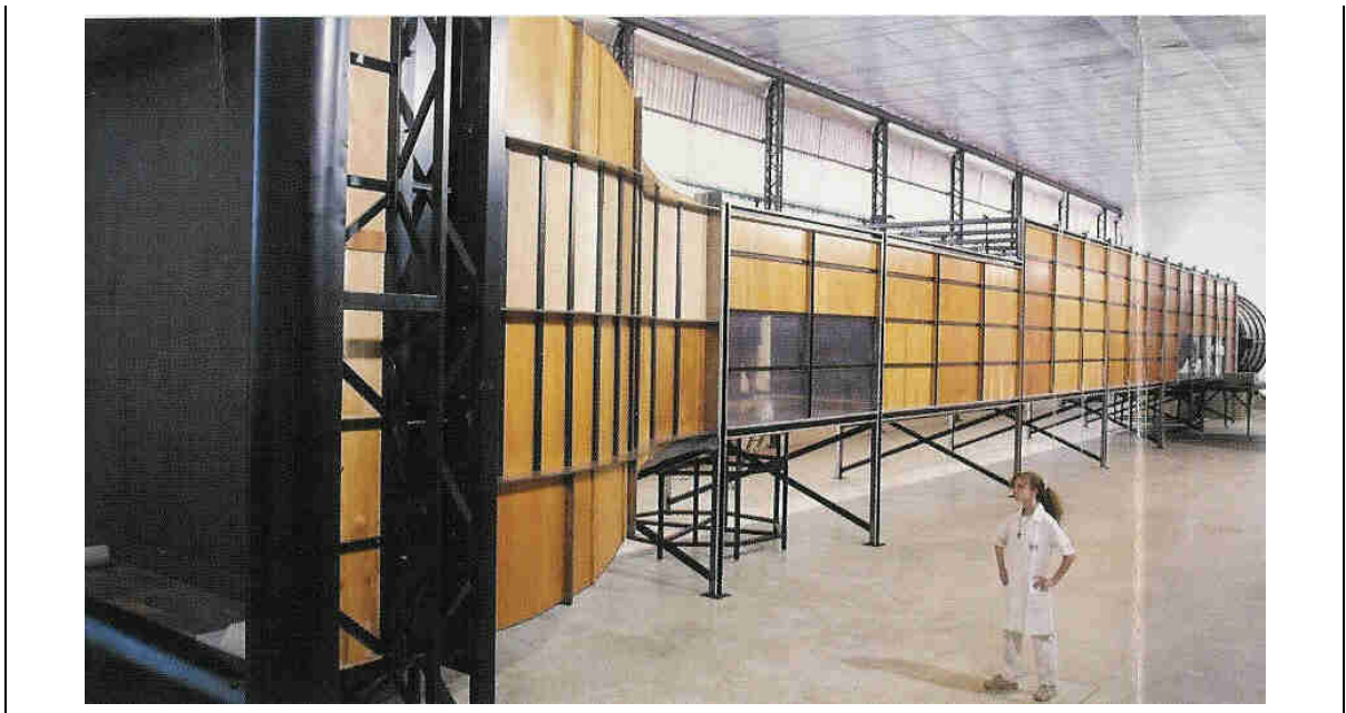
Figura 5.18: Túnel de vento experimental de camada limite atmosférica (circuito aberto) Agrupamento de Vazão do Instituto de Pesquisas Tecnológicas do Estado de São Paulo.
