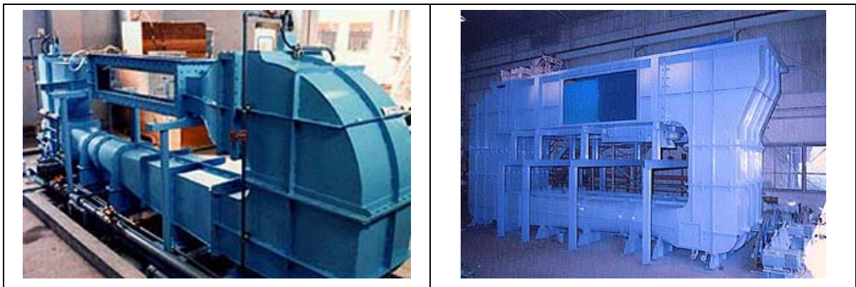
Figura 5.20: (a) Canal de água utilizado para ensaios aerodinâmicos e (b) para ensaios de engenharia de pesca. Ambos são canais de circuito fechado vertical.
