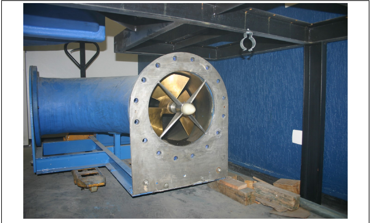
Figura 5.34: Montagem do canal. Destaque do hélice de três pás do grupo propulsor.
